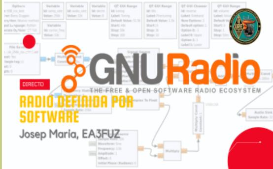
**GNU Radio** es una herramienta de desarrollo bajo licencia pública general de GNU (GNU GPL) que permite la implementación de sistemas de "radio definida por software" a través de un "front end" de radio, un ordenador y diferentes bloques predefinidos en la "suite" de GNU Radio tales como filtros, moduladores / demoduladores, etc.
